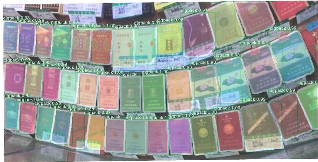
图 6 卷烟烟盒检测结果, 其中绿框表示检测得到外接矩形, 不同颜色的色块表示烟盒的实际区域 Fig. 6 Cigarette cases segmentation results. The green rectangles represent the predicted bounding boxes, and blocks of different colors indicate the actual area of the cigarette case
